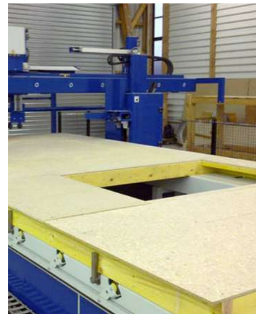
Збірні дерев'яні каркасні елементи Prefab modular timber frame elements for facade
